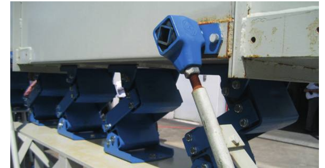
Zaranda de una masa con acumuladores ROSTA SE ®
